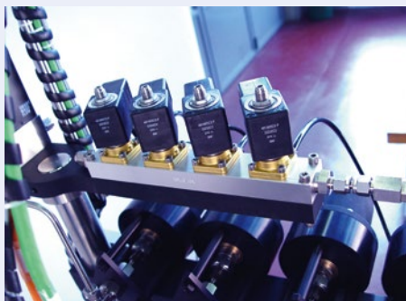
Manifold with control valves for massflow-controller Verteiler mit Steuerventilen für Durchflussmessung
